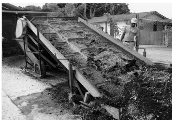
Figura 4. Máquina de revolvimento de composto orgânico (em funcionamento) produzida na UEPA, INCAPER de Linhares-ES. 2009.
