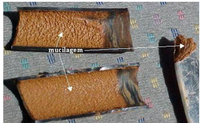
Figura 2. Mucilagem formada nas paredes internas dos tubos de polietileno de baixa densidade com detalhe de uma raspagem feita com canivete em um segmento do tubo
