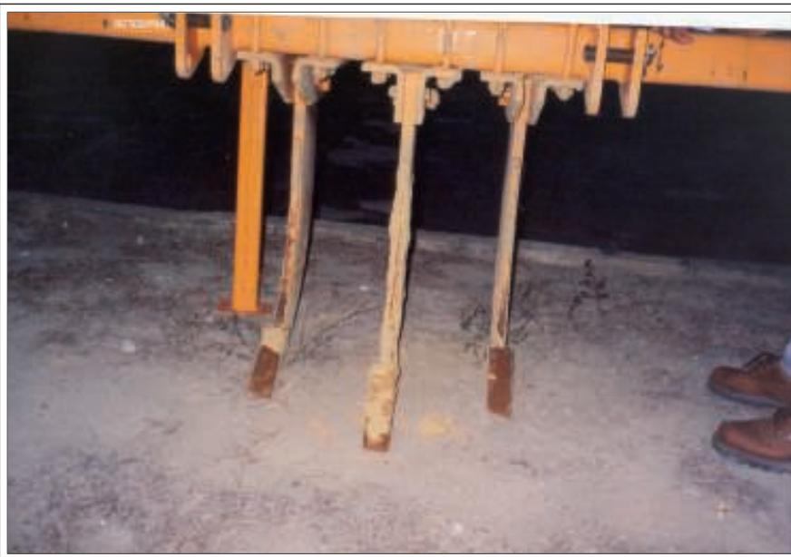
**Figura 3.** Subsolador de três hastes para rompimento de camadas compactas do solo.
