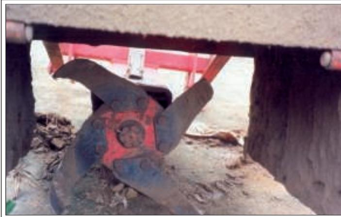
**Figura 4.** Detalhe interno do bater de covas.
