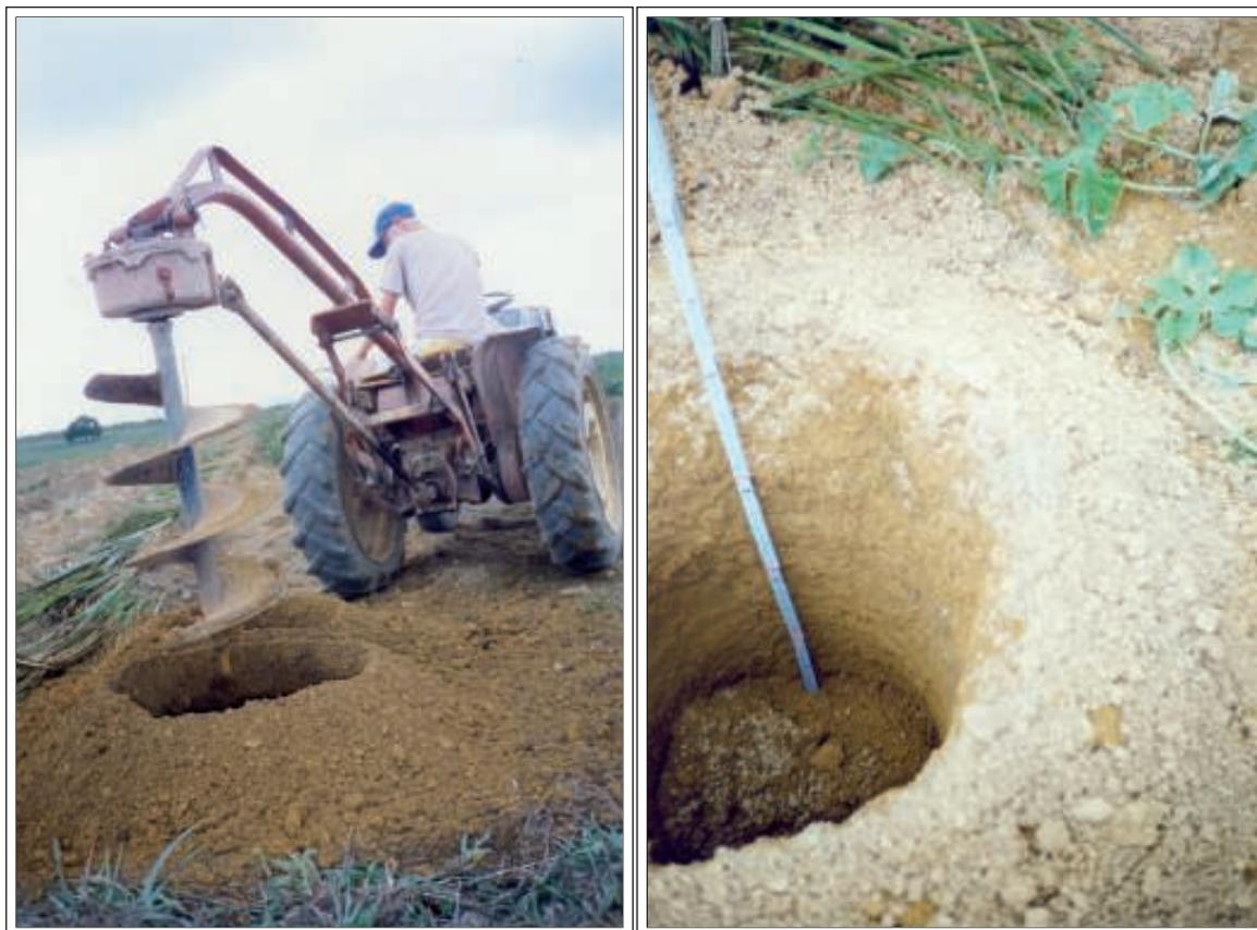
**Figura 6.** “Brocão” – broca de solo com diâmetro de 18” empregada na abertura de covas. **Figura 7.** Detalhe da cova aberta pelo “brocão”.
