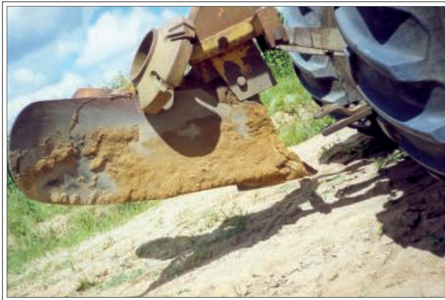
**Figura 1.** Sulcador alado de profundidade e largura variáveis, empregado na implantação das lavouras em solo de relevo plano.
