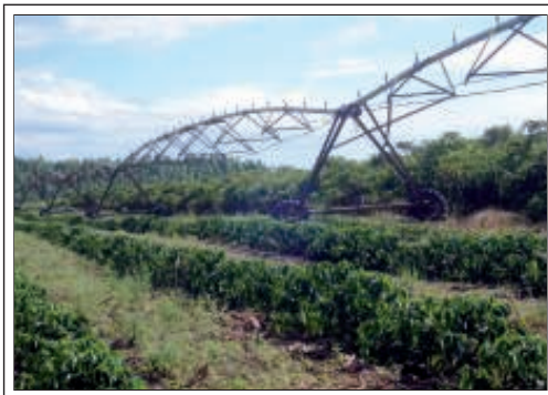
Figura 8. Vista de um pivô central utilizado para irrigar lavoura de café.
