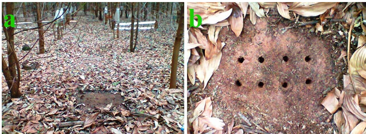
Figura 5 - (a) Locais de coletas na entrelinha de plantio e (b) Buracos após a coleta de solo
