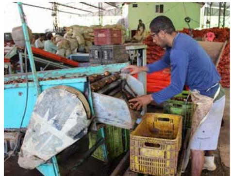
**Figura 8.** Composição da infraestrutura mecânica para o beneficiamento e classificação dos cormos de taro (inhame). Após a lavagem segue-se à: escovação, classificação (local de saída dos “dedos” pequenos), descarte manual e classificação (saída de “dedos” graúdos).
