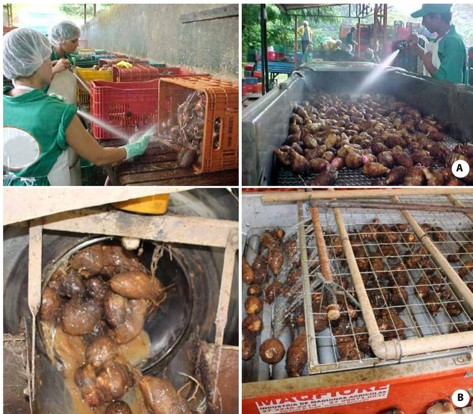
**Figura 6.** Detalhes da lavagem dos “dedos”, com o uso de jatos d’água (A) e por imersão em água em lavador seguido do enxágue (B).
