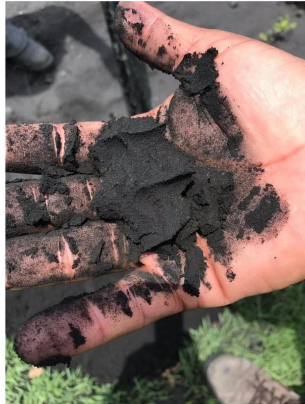
Os co-produtos oriundos da Lama de Alto Forno; Pó do Alto Forno e da Escória KR-01-01 são caracterizados pela baixa granulometria e baixo poder de agregação e coesão, passíveis de arraste de particulados pela ação dos ventos, gerando um passivo ambiental, que acarreta na presença de particulados na atmosfera nas regiões do entorno do ambiente industrial..
