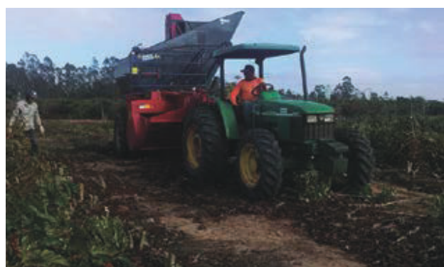
Figura 4. Trilhadora de café conilon tracionada e acionada por trator na safra 2013/14 em Pinheiros-ES.
