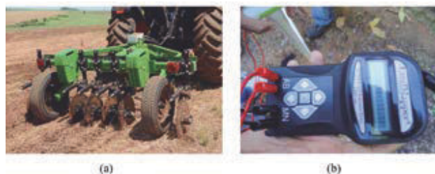
Figura 8. Condutímetro tratorizado (a - Veris) e portátil (b - LandMapper) utilizados para determinação da condutividade elétrica aparente do solo.
