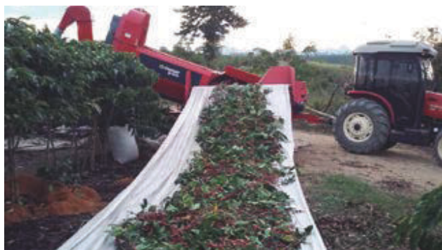
Figura 3. Recolhedora de lona tracionada e acionada por trator na safra 2016/17 em Governador Lindenberg-ES.
