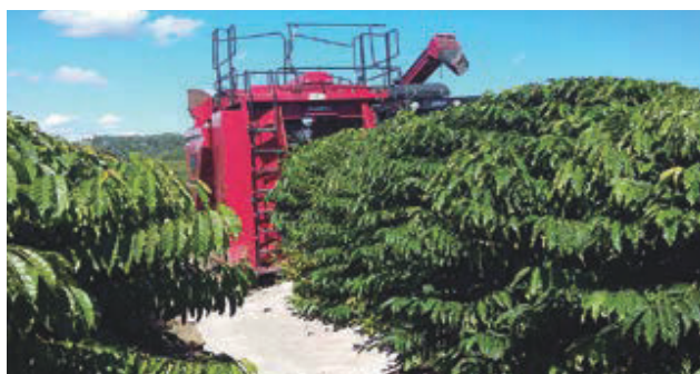
Figura 5. Colhedora automotriz de varetas vibratórias testada em lavouras de café conilon na safra 2016/17 em Governador Lindenberg-ES.
