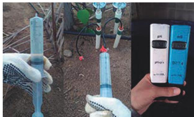
**Figura 1.** Extração da solução do solo, solução do solo extraída, medidor portátil de pH e condutividade elétrica.
