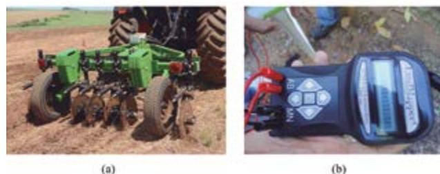
**Figura 8.** Condutivímetro tratorizado (a - Veris) e portátil (b - LandMapper) utilizados para determinação da condutividade elétrica aparente do solo.
