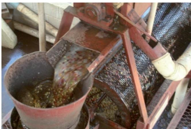
Figura 1B. Entrada dos grãos descascados e da casca no separador de casca.
