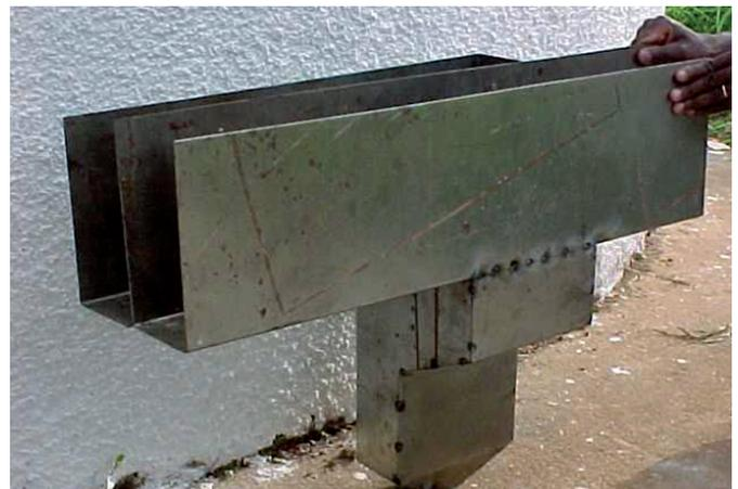
**Figura 17.** Calha de separação do lavador “Maravilha”.
