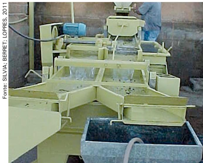
**Figura 3.** Sistema mecânico para lavagem e separação hidráulica do café.
