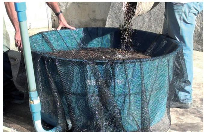
**Figura 7.** Lavador rústico para café utilizando caixa d'água e tela sombrite.
