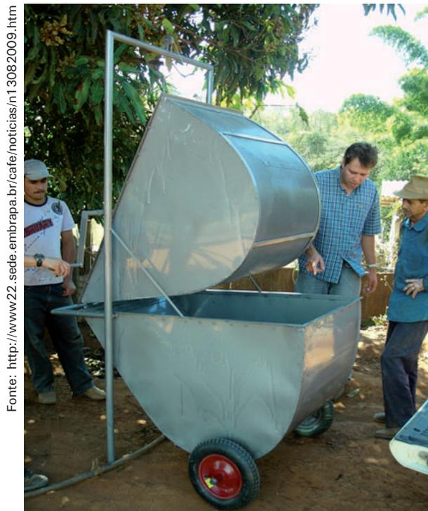
**Figura 5.** Lavador móvel com sistema basculante para descarga do café cereja.
