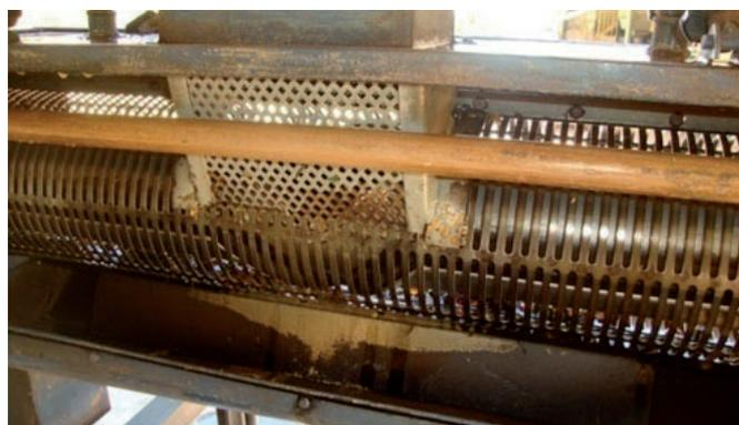
Figura 1A. Cilindro do descascador.
