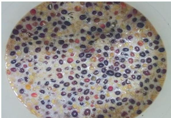
**Figura 3.** Fermentação induzida com uso de microrganismo – *Saccharomyces Cerevisiae* (dentro do tanque de fermentação).
