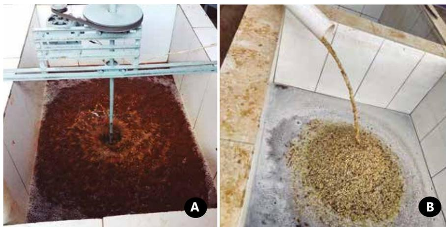
**Figura 31.** Finalização da retirada da mucilagem através de bater mecânico (A); na sequência, os grãos são colocados em tanque para fermentação biológica (B).
