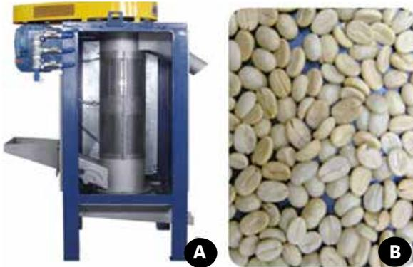
**Figura 30.** Desmucilador mecânico de café (A) e café desmucilado mecanicamente (B).
