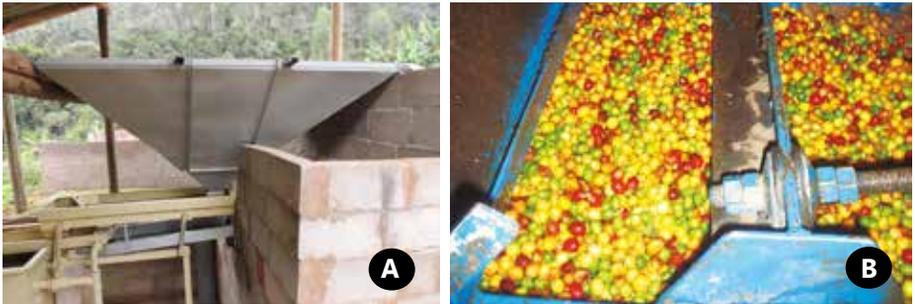
**Figura 27.** Visão externa (A) e funcionamento do equipamento para separação de cafés secos/verdes/maduros (B).
