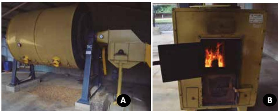
**Figura 35.** Vista externa do secador de café (A) com fornalha de fogo indireto (B).
