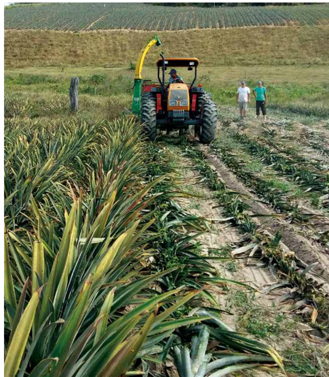
Figura 3 - Colheita mecanizada dos subprodutos do abacaxizeiro para ensilagem.
