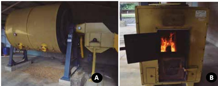
**Figura 35.** Vista externa do secador de café (A) com fornalha de fogo indireto (B).
