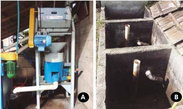
**Figura 28.** Descascador/separador de cereja (A) e caixa de reciclagem da água (B).
