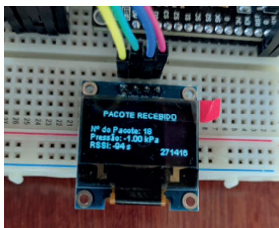
Figura 12. Circuito recebendo leituras do circuito transmissor.
