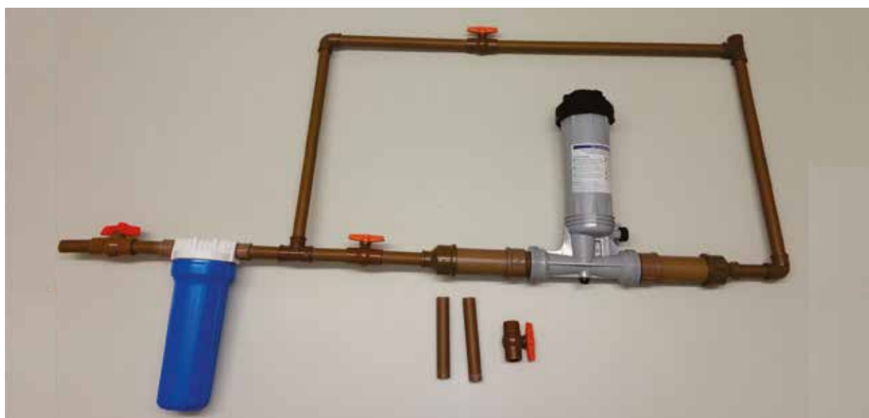
Figura 16 – Peças de cano com 10 cm e registro.
