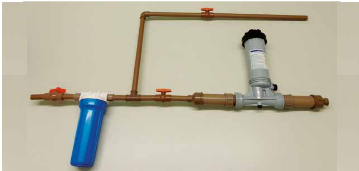
Figura 15 – Peças de cano com 10 e 45 cm, conexão em T (tê) e conexão em 90° (joelho).
