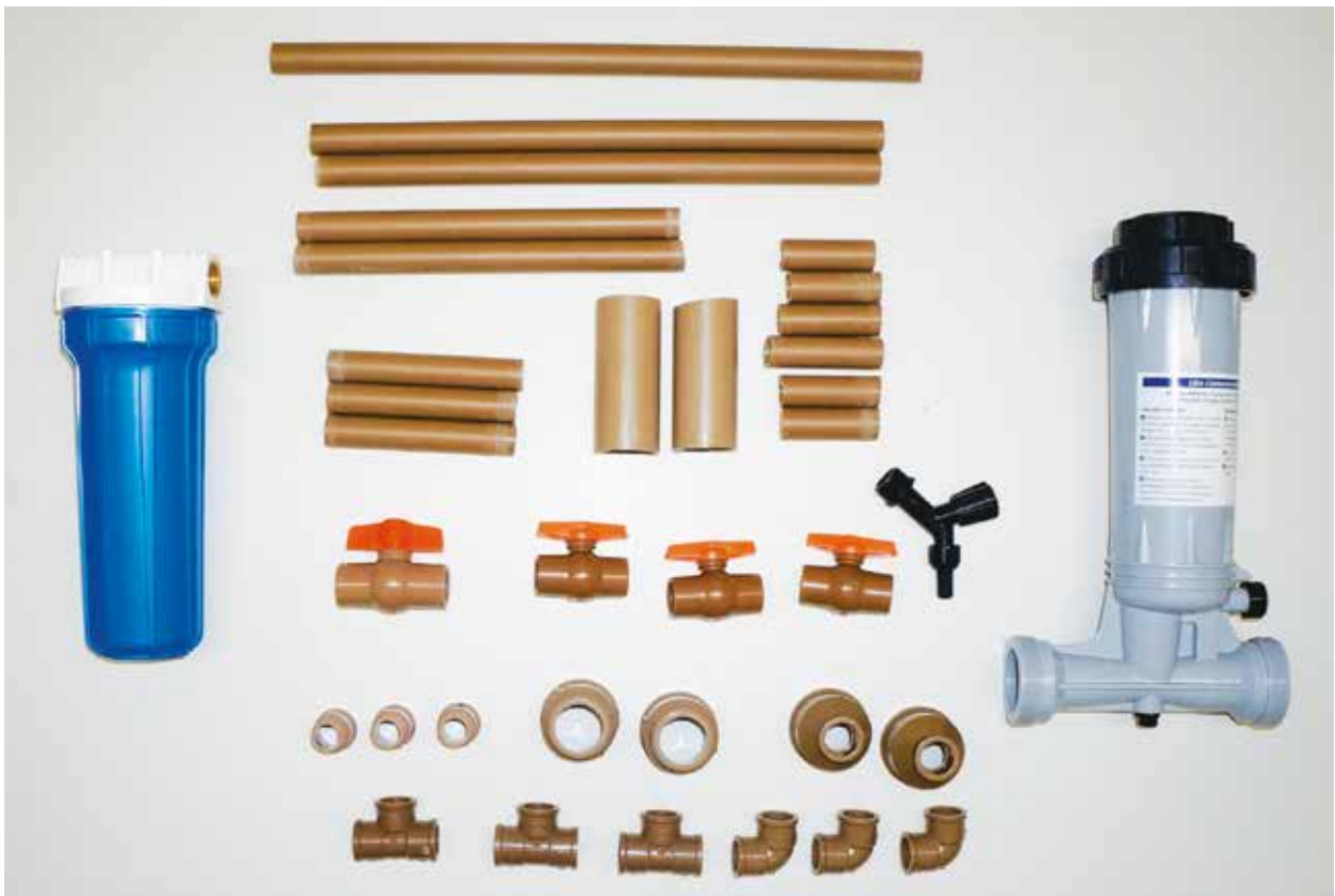
Figura 5 – Materiais necessários para instalação do filtro e clorador.
