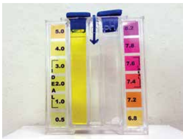
Figura 23 – Água com concentração de cloro de 4,0 mg/L (cor amarela intensa).
