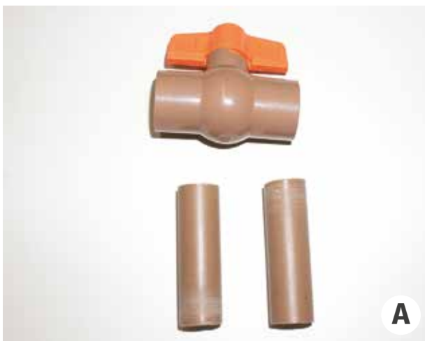
Figura 6 – Pedaços de cano de 10 cm e registro (A); peças de cano conectadas ao registro (B).
