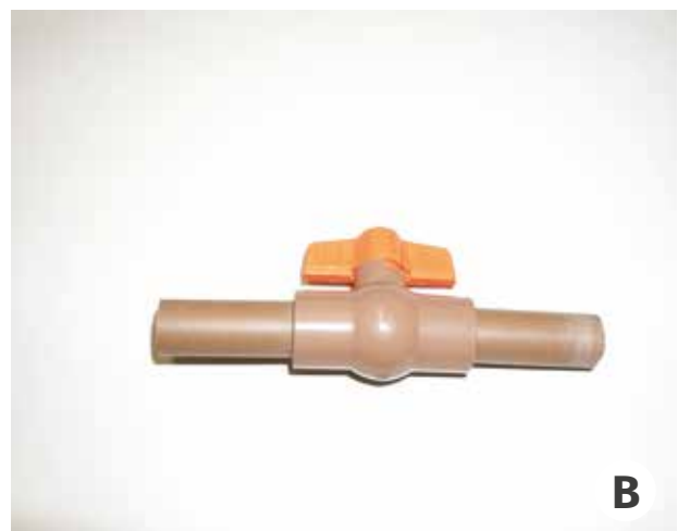
Figura 6 – Pedaços de cano de 10 cm e registro (A); peças de cano conectadas ao registro (B).
