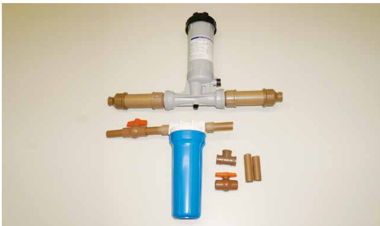
Figura 11 – Peças das etapas 3 e 5, conexão em T (tê), registro e duas peças de cano de 10 cm.
