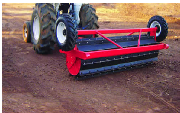
Figura 4: Implemento para sementeira em plantio direto, de tração animal ou microtrator (acima) e rolo-faca para acamamento de palhada, de tração mecânica (abaixo).
