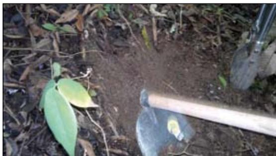
A retirada do solo foi realizada com o auxílio de cavadeira de duas bocas, articulada, em aço inoxidável (Figura 9), sendo acondicionadas em baldes de polietileno até a retirada das 10 subamostras. Mesmo procedimento para as duas profundidades (Figura 10). Em seguida,
