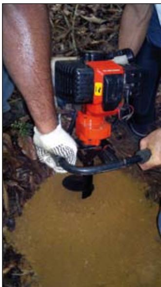
**Figura 13.** Retirada da amostra em profundidade.
