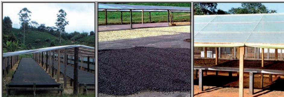
**Figura 25.** Secado del café en terreros de cemento o suspendido.
