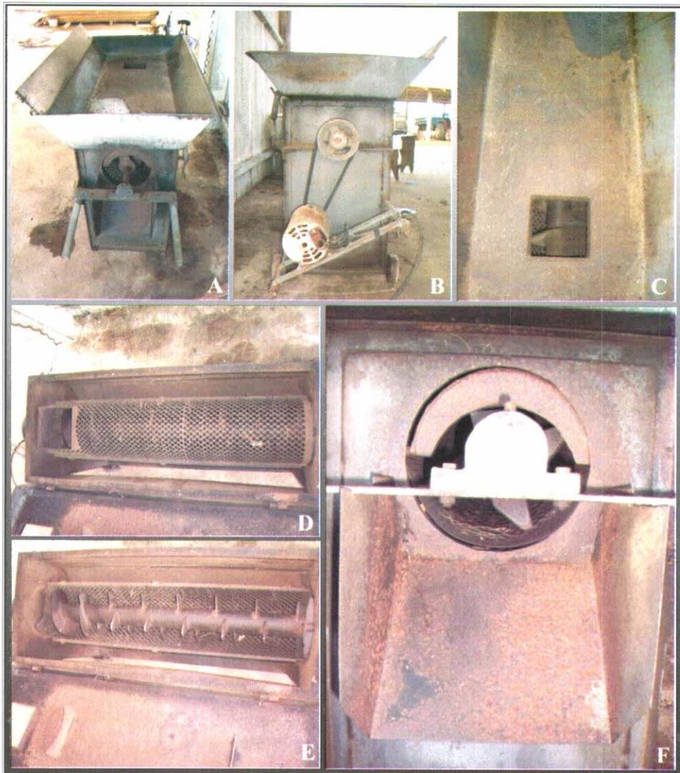
**Figura 4.** Debulhador mecânico de cachos de pimenta-do-reino: A - mesa de recepção; B - motor; C - entrada do debulhador; D - detalhe da peneira de chapa perfurada que envolve a rosca sem fim; E - detalhe da rosca sem fim; e F - local de saída da pimenta-do-reino debulhada.
