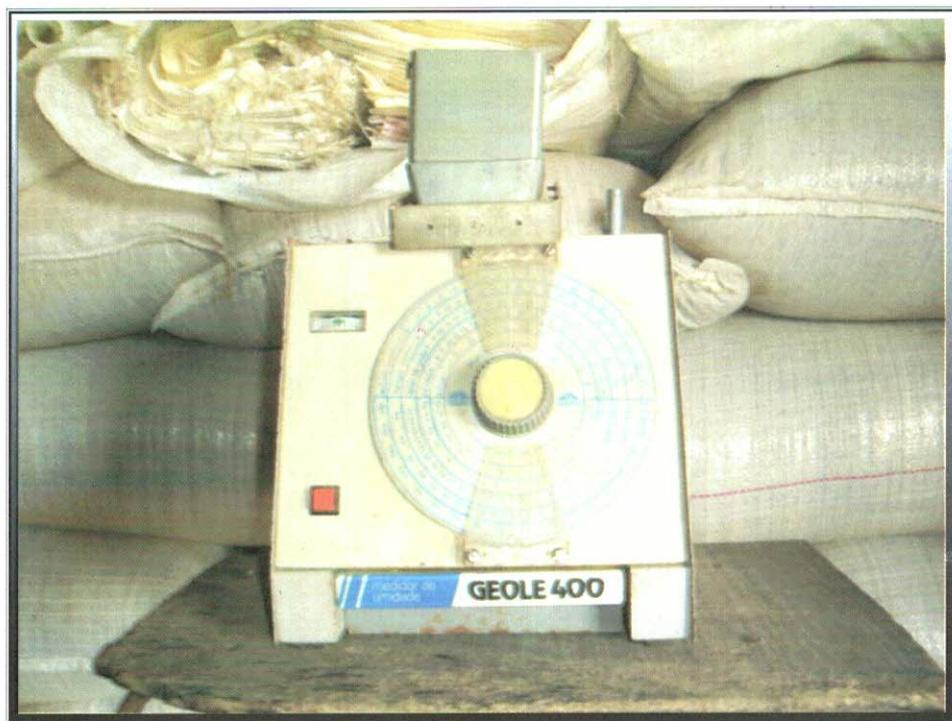
**Figura 13.** Aparelho utilizado para determinação do teor de umidade de grãos.
