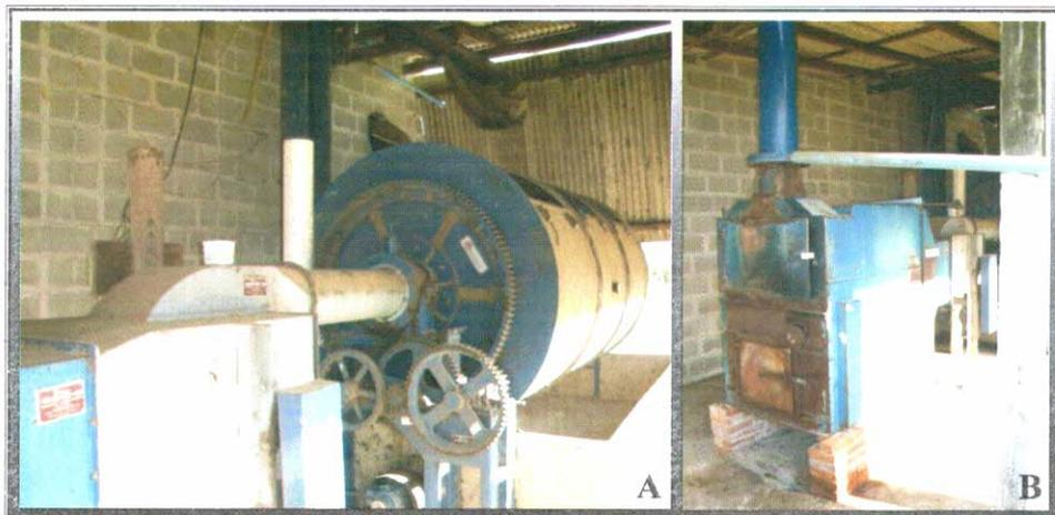
**Figura 8.** Secador com fornalha de fogo indireto: A - secador; e B - fornalha com chaminé.
