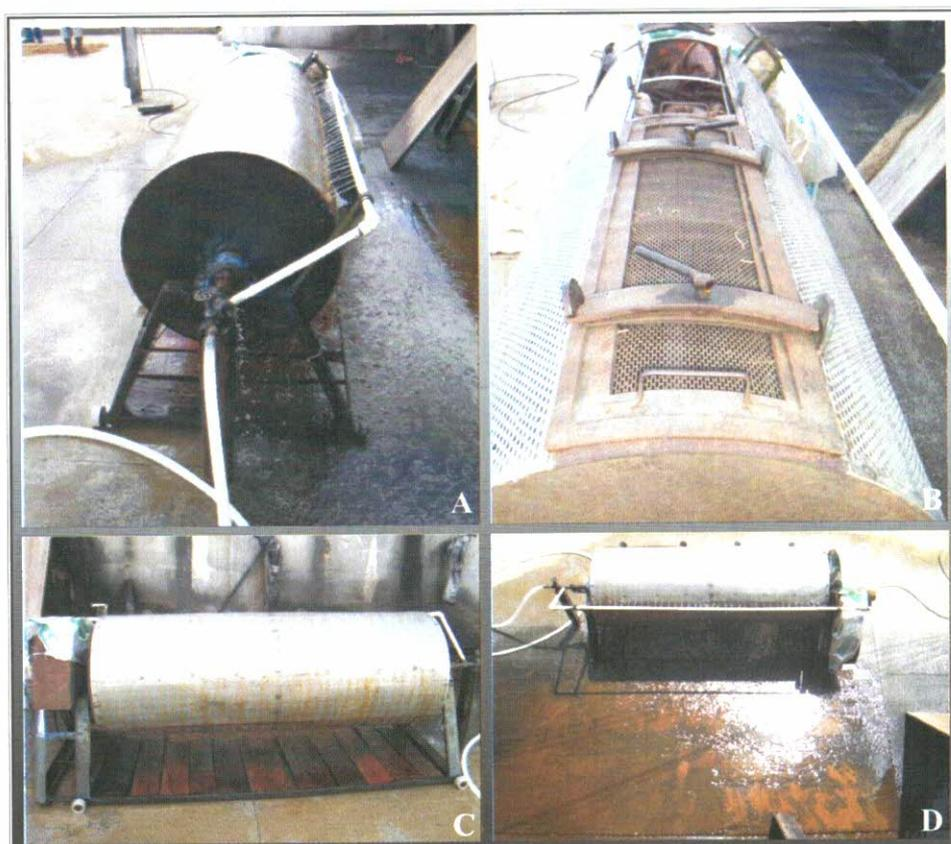
**Figura 16.** Despolpador de pimenta-do-reino: A - visão lateral mostrando a entrada contínua de água no sistema; B - tampa de abertura; C - visão frontal; D - escoamento da água utilizada no processo.
