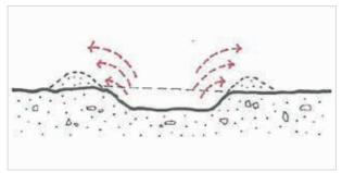
Figura 4 - Afundamento do piso por deslocamento lateral do solo
