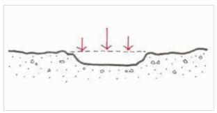
Figura 3 - Afundamento do piso por compactação Fonte: Autoria própria (2011).
