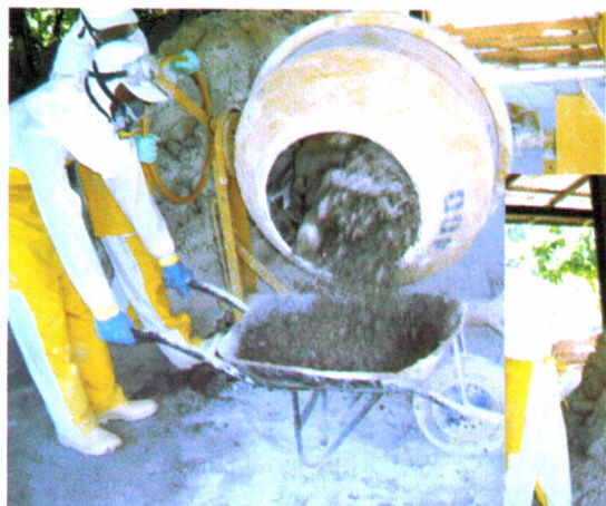
Processo de higienização do lodo de ETE.
