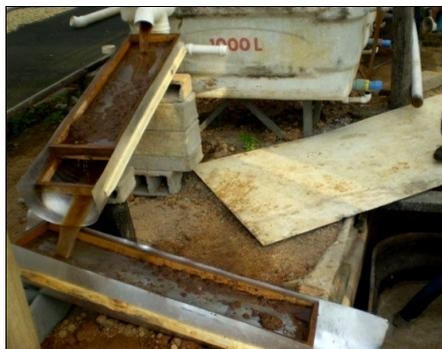
FIGURA 5. Vista parcial do sistema de remoção de sólidos suspensos da Fazenda Experimental de Venda Nova em funcionamento (Peneiras removedoras de impurezas), Venda Nova do Imigrante-ES.
