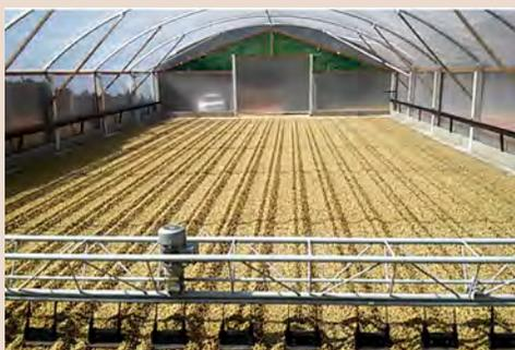
**Figura 7** – Terreiro de concreto, com cobertura plástica em PVC e revolvedor automático.
