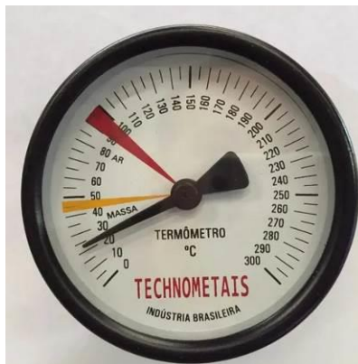
Figura 5. Termômetro utilizado em secadores mecânicos rotativos para café (fonte: internet).
