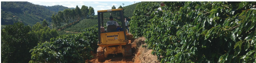
Figura 6 – Microterraceamento com trator de esteira estreito (com até 1,5 m de largura).
