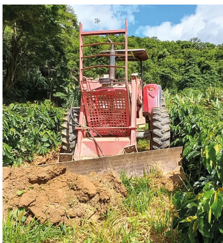
Figura 4 – Microterraceamento com trator e lâmina dianteira.
