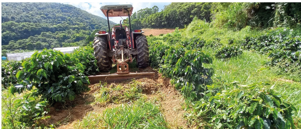
Figura 3 – Microterraceamento com trator e lâmina traseira.
