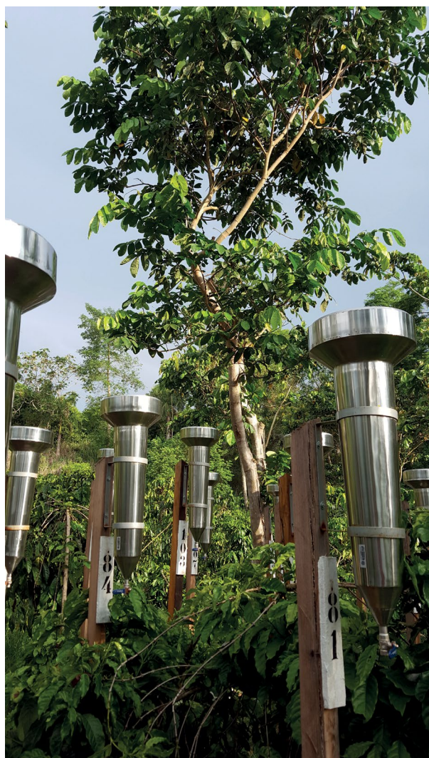
Figura 8 – Pluviômetros ( Ville de Paris ) instalados sob a copa de árvores de I. edulis para medição da água que passou pelos ramos na área do experimento.
