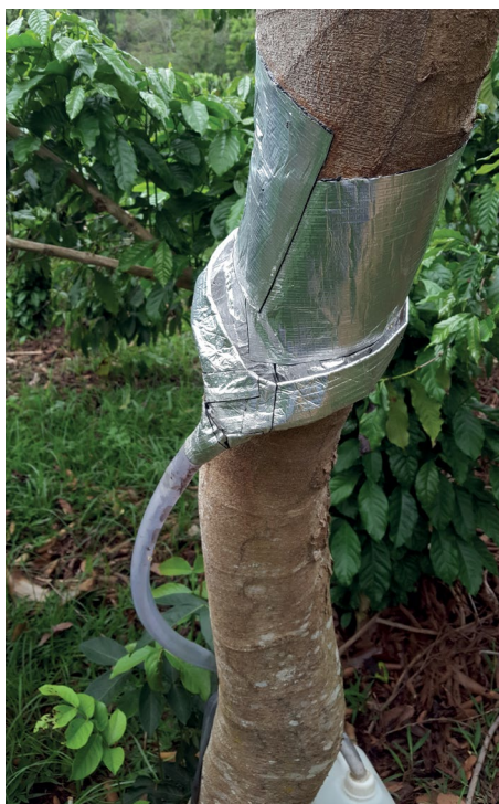
Figura 10 – Coletor feito à mão, para monitoramento da água que escorre pelos troncos, instalado em quatro árvores de referência por parcela na área de estudo.
