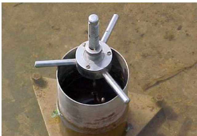
Figura 3 - Poço de alívio e parafuso micrometro para medição diária da água evaporada.
