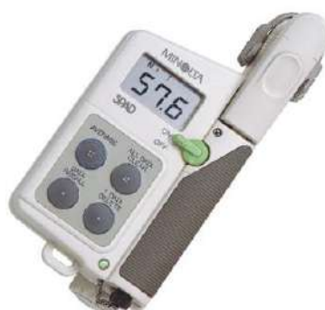
Figura 3 - Medidor portátil de clorofilas. Este equipamento estima a concentração de clorofilas totais (a+b) nas folhas, e os valores são adimensionais e variam de 0 a 100, sendo 100, uma folha com o máximo de concentração de clorofilas totais, e 0 com ausência de clorofilas totais na folha.
