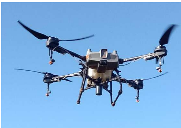
Figura 12 - Veículo aéreo não tripulado multirrotor utilizado no experimento de pulverização.
