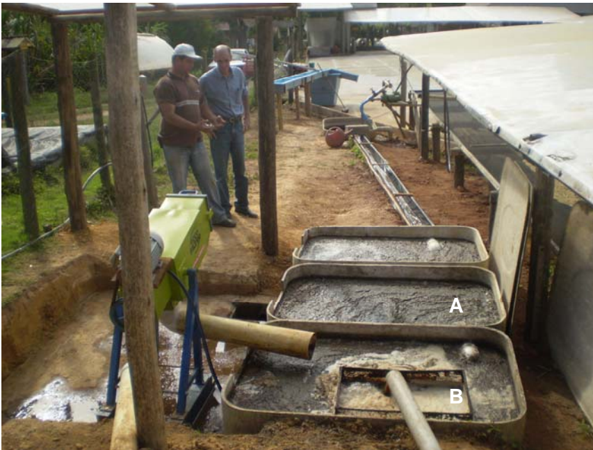
Figura 3 - Sistema de filtragem e decantação NOTA: A - Caixa de decantação. B - Caixa de retenção.
