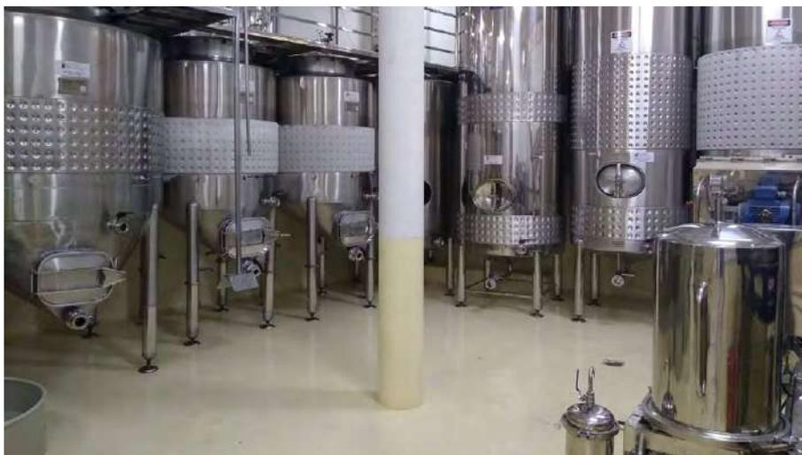
**Figura 152** – Tanques de fermentação / vinificação e armazenamento.
