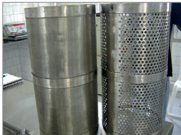
**Figura 3** - Peneiras com furos de diâmetros diferentes.
