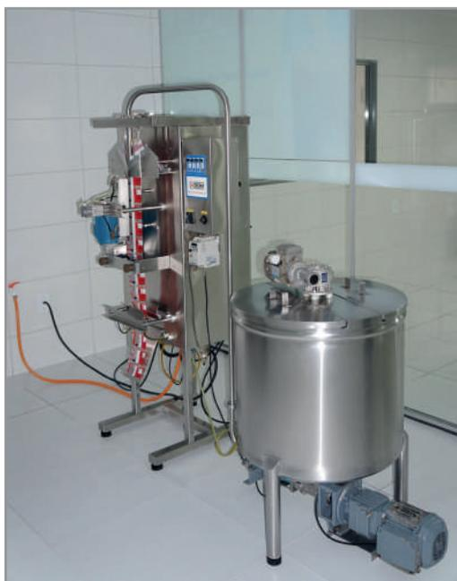
**Figura 4** - Embaladora automática com tanque pulmão.
