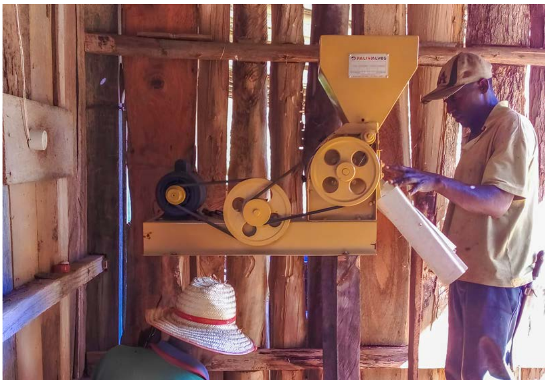
Figura 3 – Processo de descascamento de café especial, utilizando despulpador a seco, em propriedade no município de São José do Calçado/ES.
