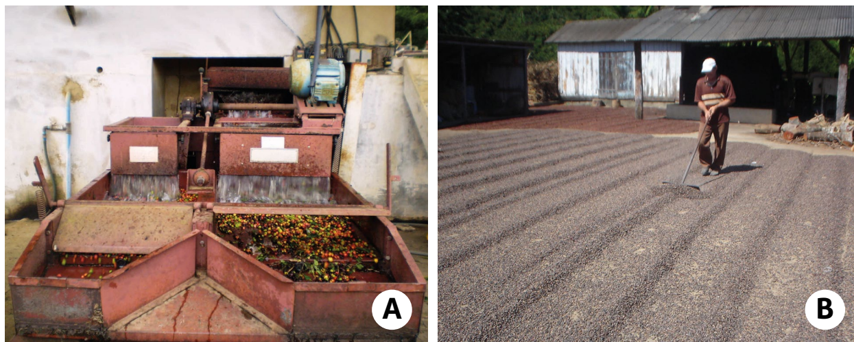
Figura 47 – Processamento do café natural com lavador/separador (A) e secagem natural do café conilon em terreiro de cimento (B).
