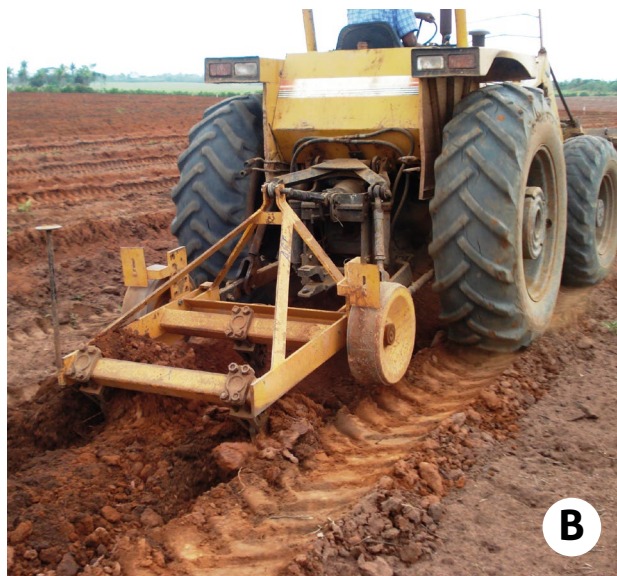
Figura 1 – Subsolador acoplado ao trator (A) e prática de subsolagem no preparo e descompactação em área para plantio (B).
