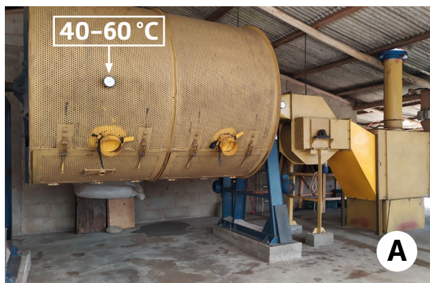
Figura 52 – Vista externa do secador rotativo de café (A) e fornalha de fogo indireto (B).
