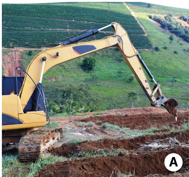
Figura 2 – Escavadeira hidráulica utilizada para preparo de sulcos em áreas declivosas (A, B).
