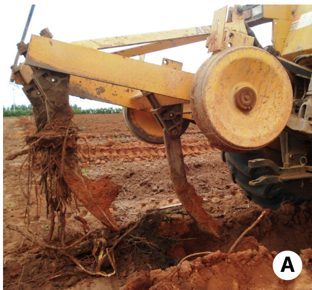
Figura 1 – Subsolador acoplado ao trator (A) e prática de subsolagem no preparo e descompactação em área para plantio (B).
