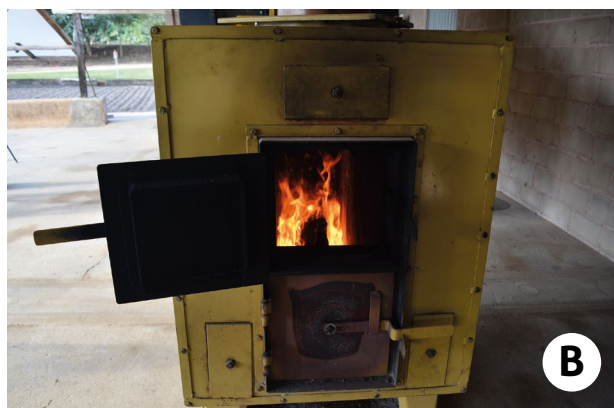
Figura 52 – Vista externa do secador rotativo de café (A) e fornalha de fogo indireto (B).
