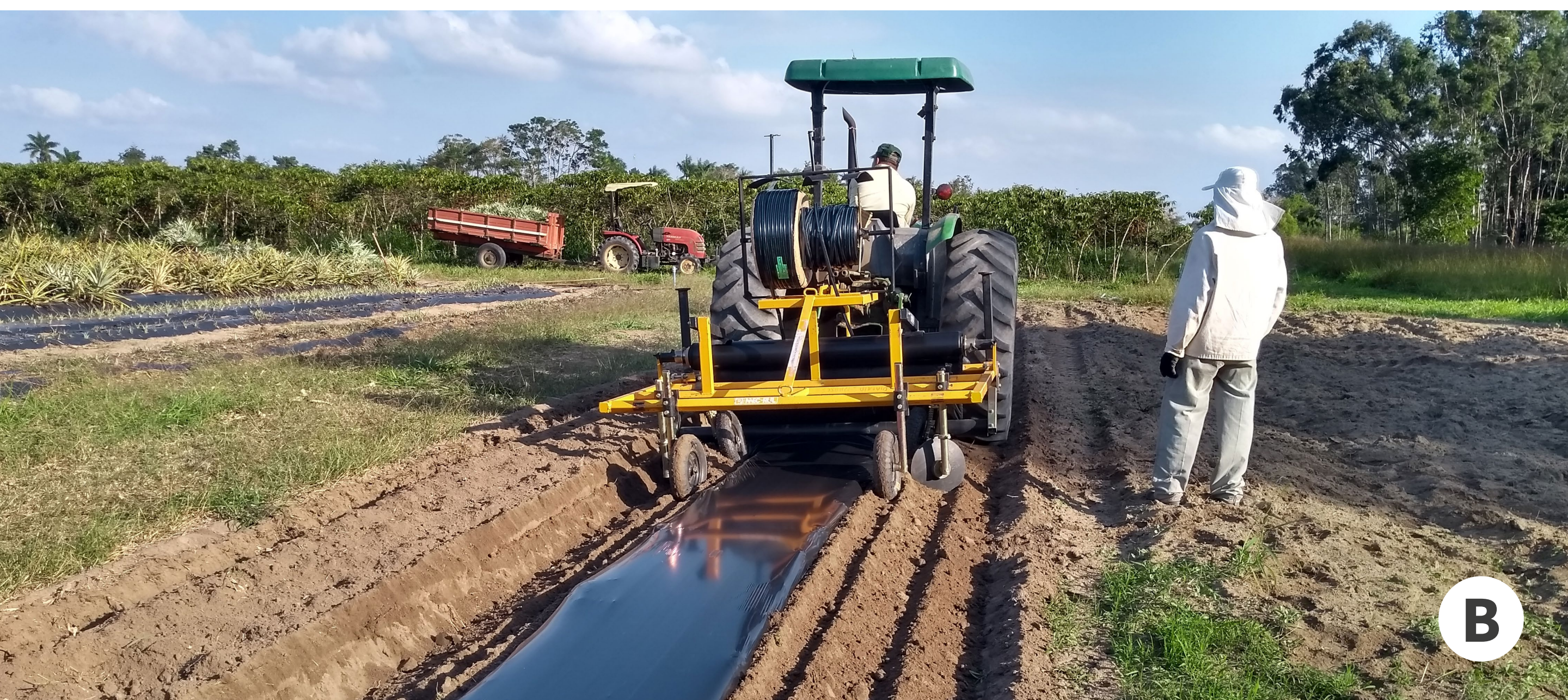
Figura 5 — Plastificadora usada no preparo dos canteiros para plantio de abacaxi com mulching plástico.
