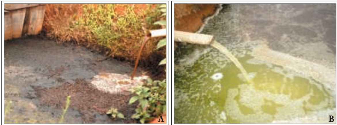
Figura 1. Água residuária do processamento dos frutos do cafeeiro: após lavagem e descascamento e com recirculação da água na unidade de processamento (A); após lavagem e sem recirculação (B).
