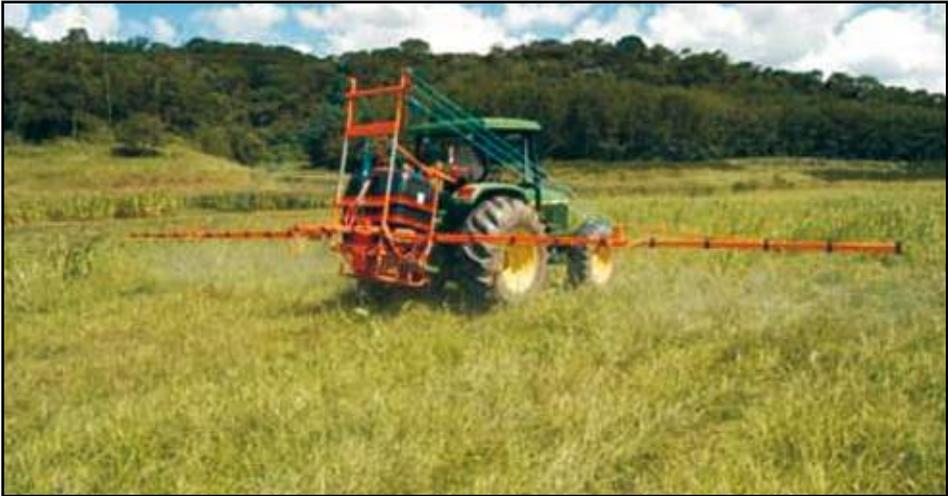
**Figura 7** - Pulverizador de barra acoplado ao trator.
