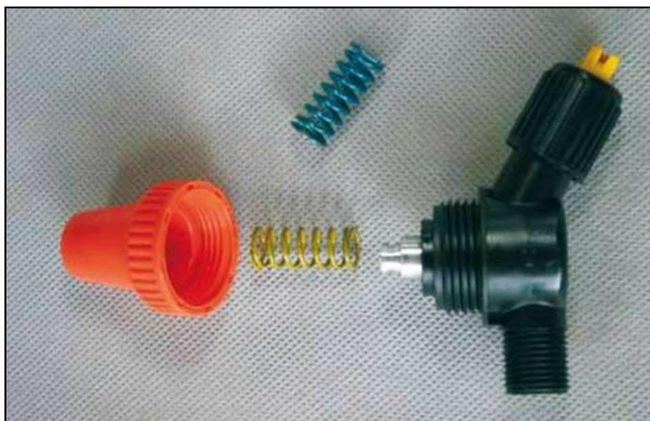
**Figura 3** - Válvula reguladora de pressão com molas amarela (1 bar) e azul (2 bar).
