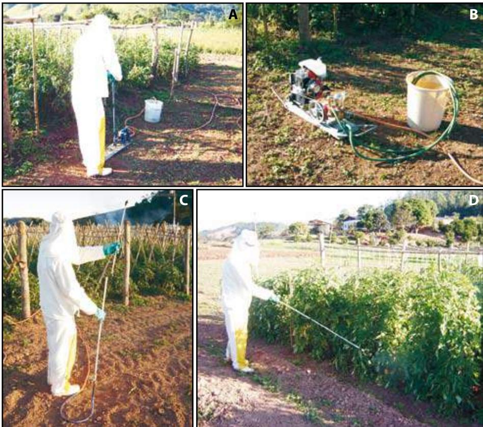
**Figura 6** - Pulverizadores estacionários com acionamento manual (A) e motorizado (B); lança com extensor para reduzir a exposição do aplicador (C e D).
