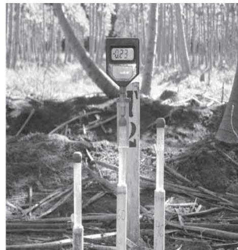
FIGURA 3. Partes constituintes do tensiômetro e principais tipos de tensiômetros encontrados em campo: com vacuômetro (A) e com leitor digital (B).
